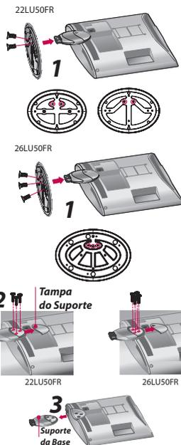
2. Caso queira instalar seu aparelho em uma parede, remova a tampa do suporte e em seguida os parafusos conforme a figura acima.
