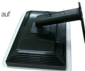
2. Drücken Sie auf die Verriegelungen und drehen Sie den Standfußsockel zum Abnehmen von der Standfußverbindung in Pfeilrichtung.
