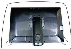
2. Montieren Sie den Standfußsockel richtig herum an der Standfußverbindung, wie in der Abbildung gezeigt.
