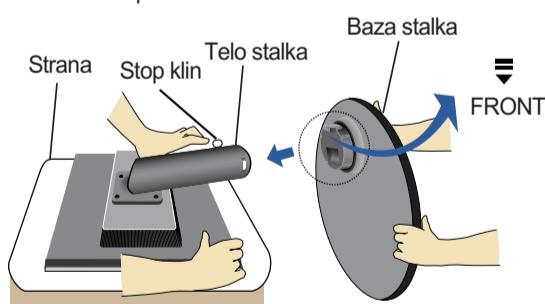
3. Osovite monitor, a zatim izvuèite Stop klin.
