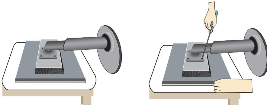
3. Installieren der Halterung für die Wandmontage.
