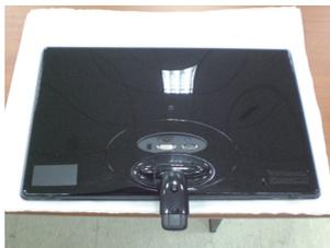
2. Avec une pièce, tournez la vis dans le sens des aiguilles d'une montre pour la serrer au dos de la base support.
