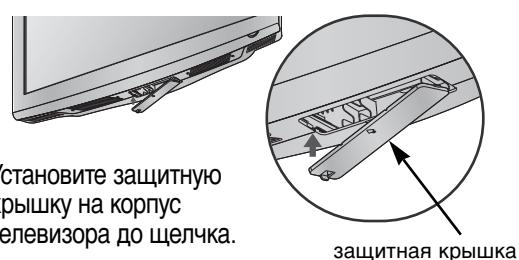
Установите защитную крышку на корпус телевизора до щелчка.
