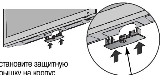
Установите защитную крышку на корпус телевизора до щелчка.
