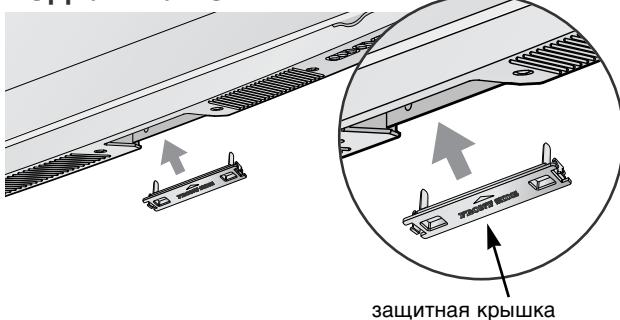
Установите защитную крышку на корпус телевизора до щелчка.
