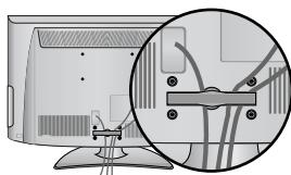
**Как снять хомут для фиксации проводов (МОДЕЛИ Жидкокристаллический телевизор : 19/22LH20\*\*, 19/22LD3\*\*, 19/22LG31\*\*)**
