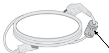
In der Nähe des Netzsteckers montieren.
