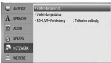
2. Das Menü [Verbindungseinst.] wird eingeblendet. Wählen Sie mit den Tasten  $\wedge/\vee$  den Eintrag [Kabel] und drücken Sie ENTER (⊙).
