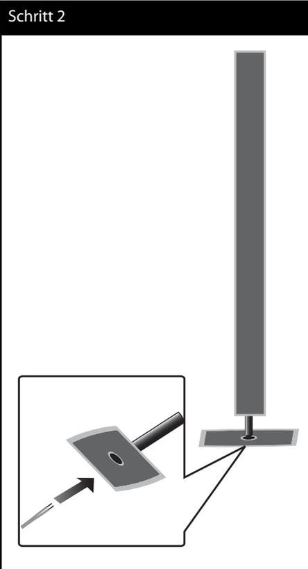
3. Schließen Sie das Lautsprecherkabel am Anschluss des Lautspechers an.
