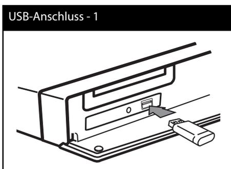
Bei Anschluss eines USB-Gerätes bei eingeblenndem Hauptmenü werden auf dem USB-Speichergerät enthaltene Musikdateien automatisch wiedergegeben. Falls auf dem USB-Speichergerät verschiedene Dateitypen gespeichert sind, wird ein Menü zur Auswahl des Dateityps eingeblendet.
