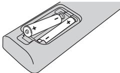
Nehmen Sie die Batteriekappe von der Rückseite der Fernbedienung ab und legen Sie zwei R03-Batterien (Größe AAA) mit der richtigen Polung + und - ein.
