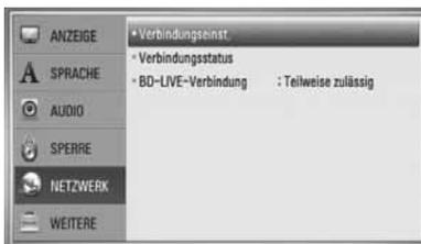
2. Das Menü [Verbindungseinst.] wird eingeblendet. Wählen Sie mit den Tasten  $\Delta/\nabla$  den Eintrag [Wireless] und drücken Sie ENTER (⊙).
