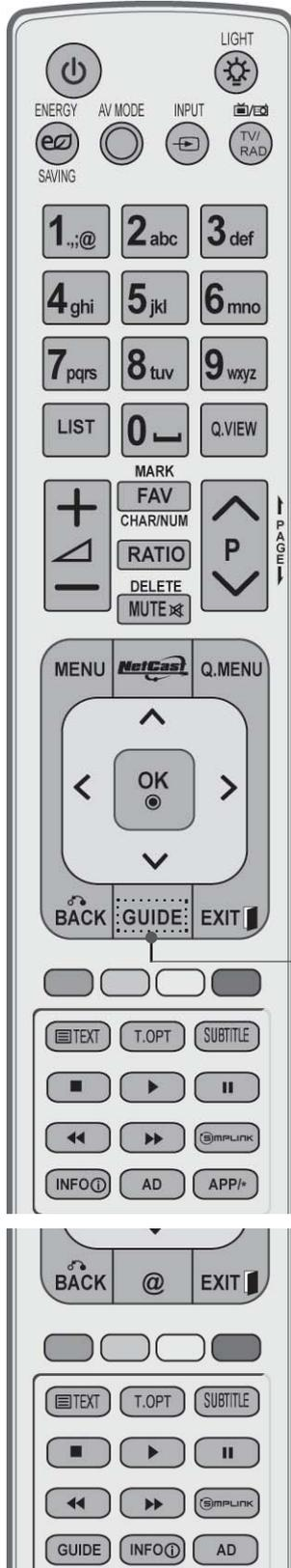
**⏻ (POWER)** Permet de mettre l'appareil sous tension lorsqu'il est en mode veille et de le mettre hors tension pour passer en mode veille.
