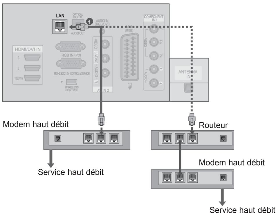
1 Raccordez le port LAN du modem ou du routeur au port LAN du téléviseur.
