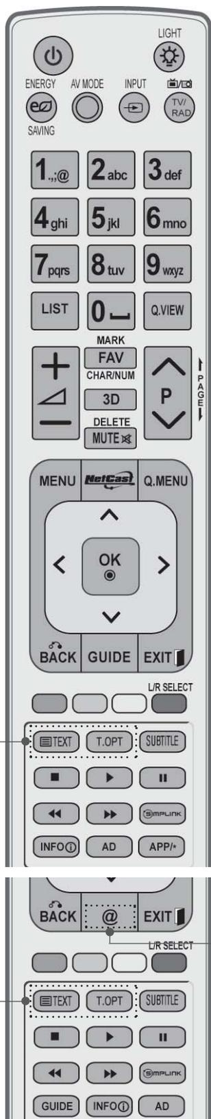
Bouton numéro 0 à 9 Permettent de sélectionner une chaîne.
