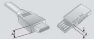
► Pour assurer une connexion optimale avec un câble HDMI (HDMI IN 4 uniquement) / un périphérique USB, n'utilisez pas des produits présentant une épaisseur supérieure à :
