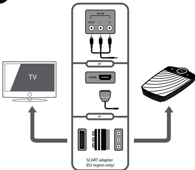
Conecte el reproductor multimedia al TV con el cable de A/V o el cable HDMI
