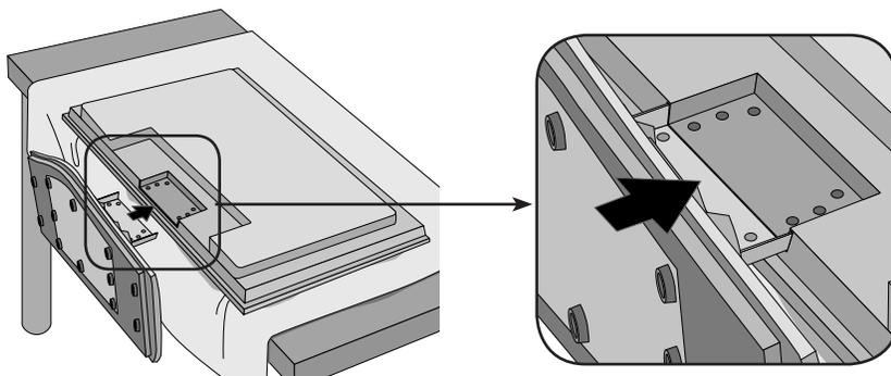
3. Utilice los tornillos para fijar el soporte a la parte posterior del producto, como se muestra en el esquema.
