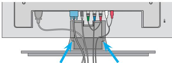
2. Ajuste la guía de cable a la parte trasera para facilitar la colocación del cableado.
