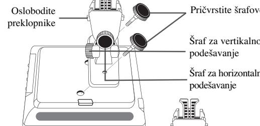
Stavite nosač postolja sa zadnje strane uređaja i fiksirajte ga pomoću šrafova.
