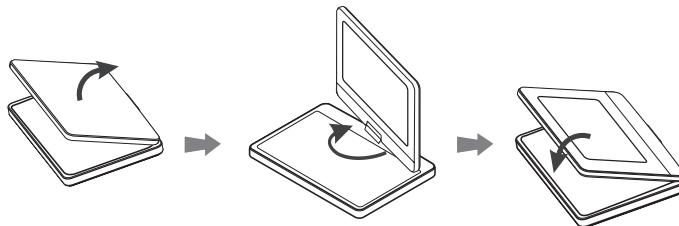
Da biste okrenuli LCD panel, postavite uređaj na stabilnu i ravnu površinu kao što je na primer sto. Otvorite ga i podignite LCD panel u vertikalni položaj. Okrenite lagano LCD panel u smeru kretanja kazaljke na satu za 180 stepeni. Ako je potrebno, preklopite LCD panel posle okretanja.
