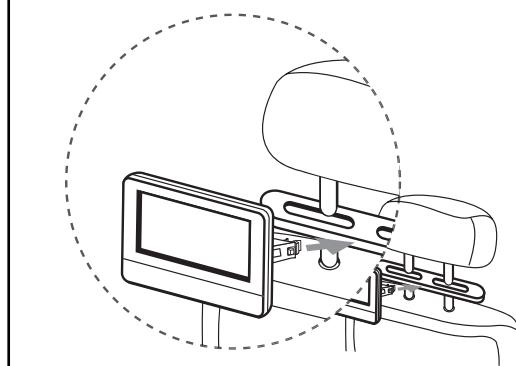
Uglavite nosač postolja zajedno sa uređajem na držać.
