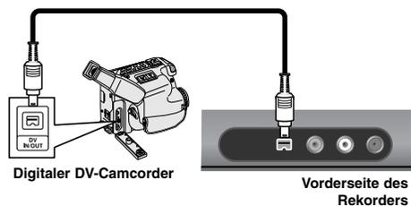
Diese DV IN-Buchse ist ausschließlich für den Anschluss eines digitalen DV-Camcorders vorgesehen und ist nicht kompatibel mit digitalen Satellitenempfängern oder D-TAPE-Videoegeräten. Beim Trennen des DV-Kabels während der Aufnahme von einem angeschlossenen digitalen Camcorder kann es zu Fehlfunktionen kommen.
