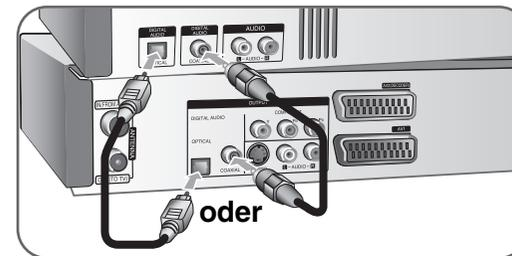
Dieser Recorder führt keine interne (2-Kanal-) Decodierung einer DTS-Tonspur durch. Um DTS-Mehrkanal-Raumklang zu genießen, müssen Sie diesen Recorder über einen der digitalen Audioausgänge des Recorders an einen mit DTS kompatiblen Receiver anschließen.
