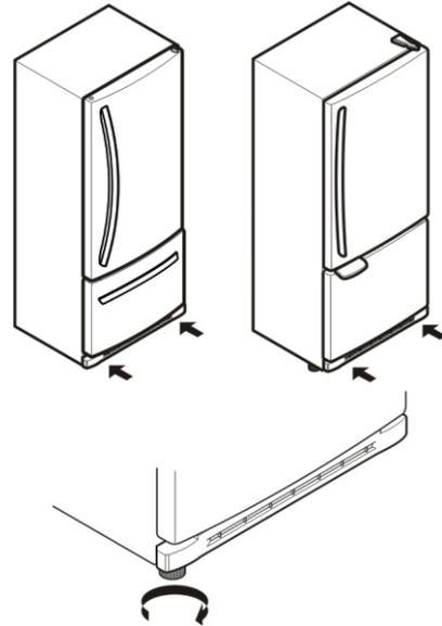
3. Abra ambas puertas y asegúrese que cierran con facilidad. Si no, incline un poco más el refrigerador hacia atrás, girando los tornillos niveladores a favor de las manecillas del reloj. Esto puede tomar varias vueltas, y deberá girar las mismas veces en ambos lados.
