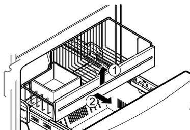
2. Para ensamblar, jale los rieles a su máxima extensión. Enganche los soportes de la canasta en las pestañas de los rieles y empujela hacia el fondo.
