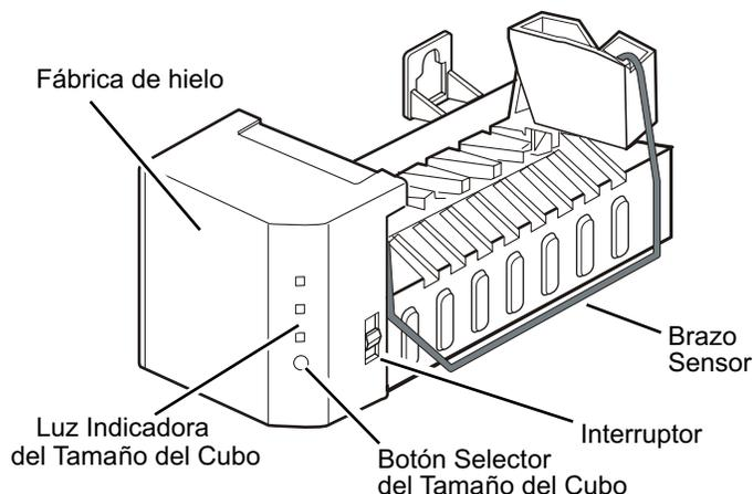
La fábrica de hielos produce 8 cubos por ciclo – entre 100 y 130 cubos en un periodo de 24 h, dependiendo de la temperatura del compartimento del congelador, número de veces en las que se abre la puerta y otras condiciones de uso.
