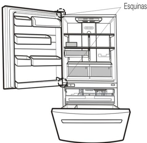
**NOTA:** Para facilitar la nivelación del refrigerador, haga que alguien levante un poco la parte superior del refrigerador. Esto quitará algo de peso sobre los tornillos niveladores.
