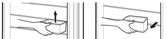
3. Para volver a colocar el recipiente, deslícelo sobre la guía deseada y empuje hacia abajo hasta que quede asegurado completamente (Ud. escuchará un "tick").
