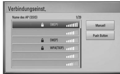
Falls der Access-Point oder Wireless-Router abgesichert ist, stellen Sie sicher, dass der im Player eingegebene WEP- bzw. WPA-Schlüssel mit dem Schlüssel des Routers übereinstimmt. Gegebenenfalls muss ein Sicherheitskennwort eingegeben werden.
