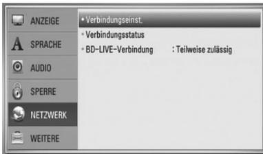
2. Das Menü [Verbindungseinst.] wird eingeblendet. Wählen Sie mit den Tasten Λ/V den Eintrag [Wireless] und drücken Sie ENTER (⊙).
