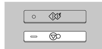
Pulse **MICOR** cuatro veces para seleccionar una potencia de 680W (80%).
