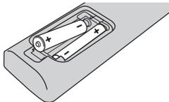
Retire la tapadera de las pilas de la parte posterior del control remoto e inserte una pila R03 (tamaño AAA) con **+** y **-** en la posición correcta.
