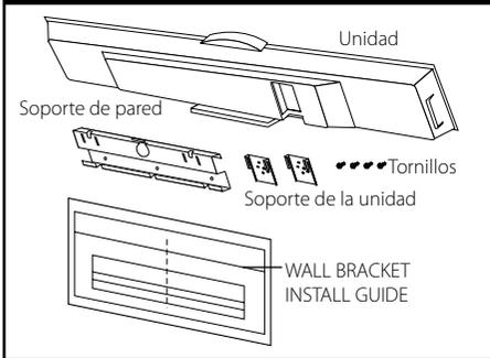
1. Una la TV BOTTOM LINE (línea inferior de la TV) de la WALL BRACKET INSTALL GUIDE (guía de instalación del soporte de pared) con la parte inferior de la TV y móntela en posición.
