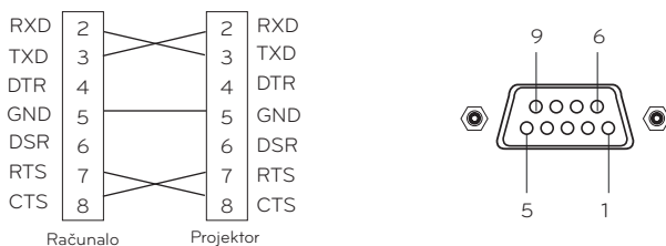
<Slika 1, RS-232 kabel sučelja>
