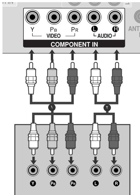
صل مخارج الفيديو (Y, PR, PB) الخاصة بصناديق الجهاز العلوي الرقمي بقوابس **COMPONENT IN VIDEO** (مكون الفيديو (ث, صا, بـ)) في الجهاز.
