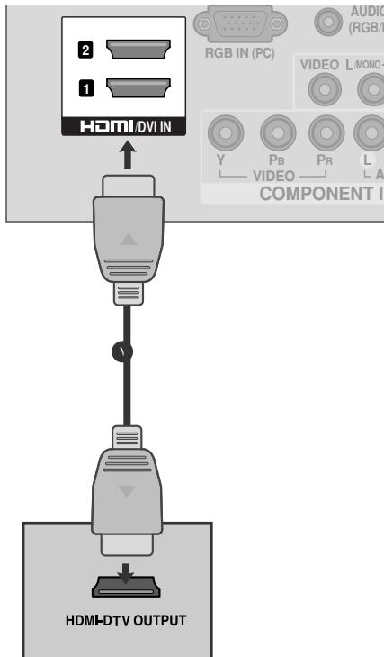
قم بتوصيل خرج **HDMI** الخاص بصناديق الجهاز العلوي الرقمي بقابس **HDMI IN3 (32/42LD4\*\*)** أو (تركيب الحامل الخاص بالطراز **HDMI/DVI IN1, HDMI/DVI IN2(19/22LD3\*\*** في **HDMI/DVI IN1, HDMI/DVI IN2(19/22LD3\*\*** في الجهاز.
