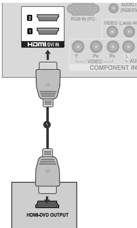
قم بتوصيل خرج **HDMI** الخاص بـ **DVD** (أقراص الفيديو الرقمية) بقابس **HDMI IN3 (32/42LD4\*\* أو HDMI IN1, HDMI/DVI IN2(19/22LD3\*\*** (بالنسبة للطراز \* بالطراز \* أو تركيب الحامل الخاص بالطراز **HDMI/DVI** في الجهاز.
