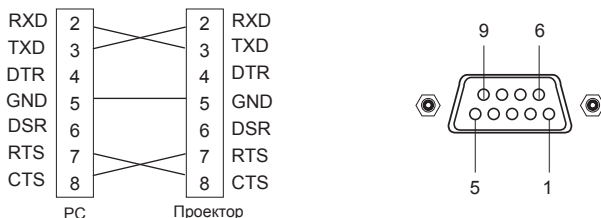
<Фиг.1, RS-232 интерфейсен кабел>
