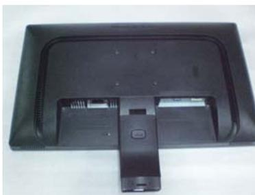
5. Pulse el botón PUSH (Presionar), extraiga la base del soporte del cuerpo.
