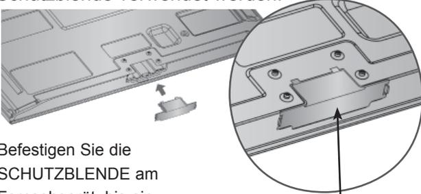
Befestigen Sie die SCHUTZBLENDE am Fernsehgerät, bis ein Klickgeräusch zu hören ist.
