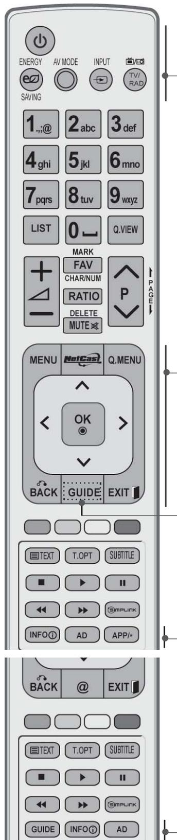
**⏻ (POWER)** Schaltet das Ger ä t aus dem Standby Ein oder in den Standby Aus.
