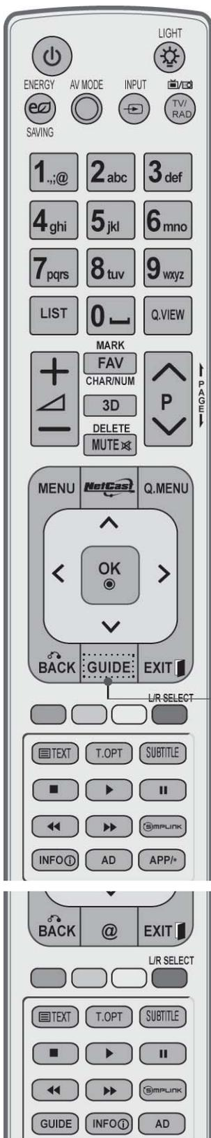
**⏻ (POWER)** Schaltet das Ger ä t aus dem Standby Ein oder in den Standby Aus.
