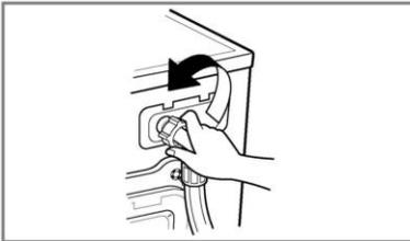
2. Den Wasserzulaufschlauch abschrauben.
