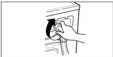
4. Den Wasserzulaufschlauch abschrauben.
