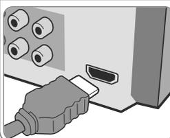
Connectez la prise HDMI OUTPUT de l'appareil à la prise d'entrée HDMI d'un téléviseur compatible avec un câble HDMI.
