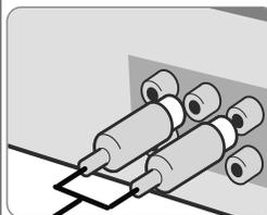
Les prises audio de l'appareil sont codées avec des couleurs (rouge pour l'audio droit et blanc pour le gauche). Si votre téléviseur ne comporte qu'une seule sortie pour le son (mono), raccordez-le à la prise audio gauche (blanche) de l'appareil.
