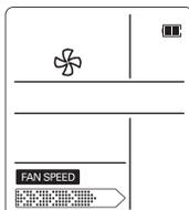
L'air circule sans effet de chauffage ni de refroidissement. Pour activer ce mode, appuyez sur le BOUTON DE SÉLECTION DU MODE DE FONCTIONNEMENT. Une fois que la circulation d'air est activée, vous pouvez sélectionner la vitesse du ventilateur en appuyant sur le BOUTON DE SÉLECTION DE LA VITESSE DU VENTILATEUR INTÉRIEUR.
