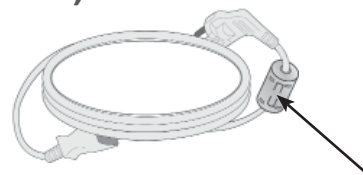
Plaats in de buurt van de stroomstekker.
