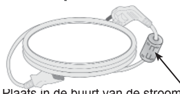
Plaats in de buurt van de stroomstekker.
