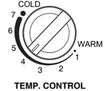
Quand la température ambiante est basse, réglez le contrôleur du réfrigérateur sur l'option 'WARM'.
