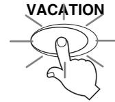
En appuyant sur 'VACATION' l'opération se met en marche avec la lampe ON et en appuyant de nouveau l'opération s'arrête. Pour un meilleur fonctionnement, vous pouvez régler le TEMP. CONTROL sur "WARM".
