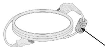
In der Nähe des Netzsteckers montieren.
