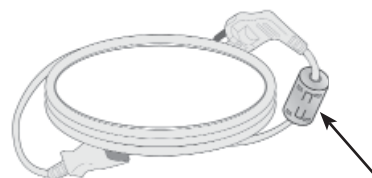
In der Nähe des Netzsteckers montieren.
