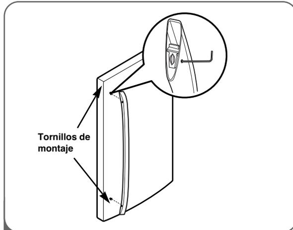
1 Coloque el tirador en la puerta, alineándolo según su plantilla, para fijar los pasadores de montaje y apriete los tornillos del conjunto con ayuda de una llave Allen de 2,5 mm (3/32").
