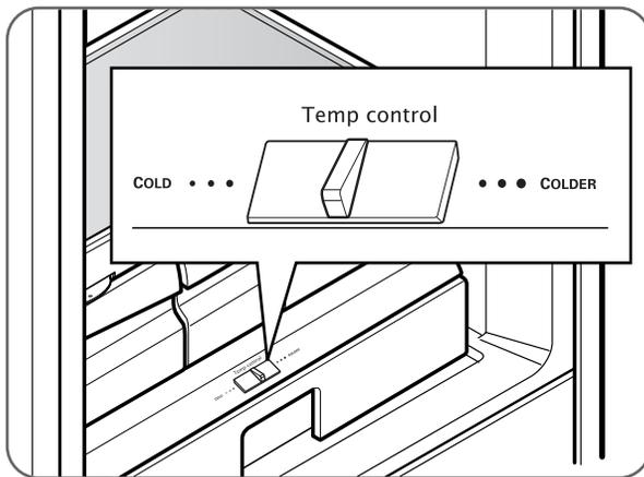
El Glide'N'Serve (Cajón Deslizante) proporciona espacio de almacenamiento con un control de temperatura variable que mantiene el compartimento más frío que el refrigerador.
