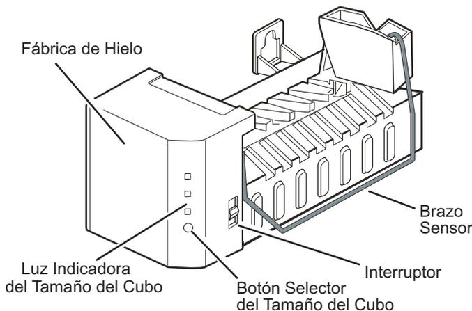
La fábrica de hielos produce 8 cubos por ciclo (entre 100 y 130 cubos en un período de 24 horas, dependiendo de la temperatura del compartimento del congelador, número de veces en las que se abre la puerta y otras condiciones de uso).
