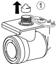
Coloque la tuerca de compresión y la férula al final de la tubería. Inserte la tubería en la válvula de conexión tan adentro como le sea posible. Apriete mientras sostiene la tubería.
