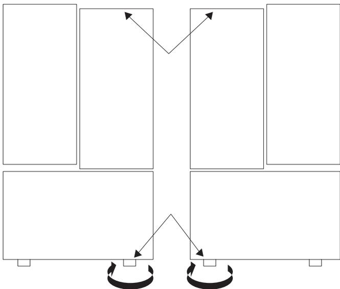
4. Abra ambas puertas otra vez, para asegurarse que cierren fácilmente. Si no, incline el refrigerador un poco más hacia atrás girando ambos tornillos en el sentido de las manecillas del reloj. Puede requerir varias vueltas más y usted deberá girar la misma cantidad a ambos tornillos niveladores.
