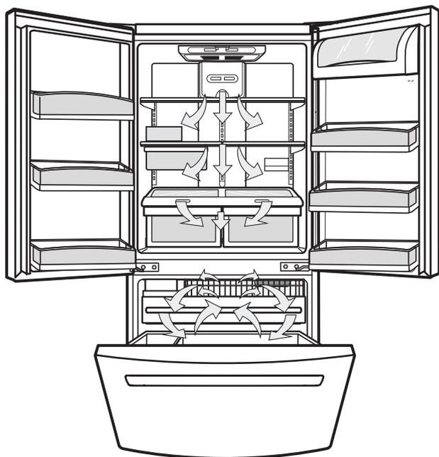
**No bloquee** ninguna de estas ventilas con paquetes de comida. Si las ventilas se bloquean, el flujo de aire se interrumpe, lo que puede ocasionar problemas de humedad.
