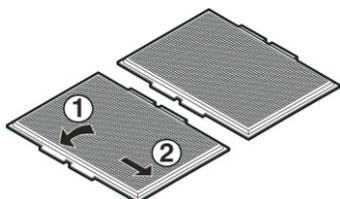
Para volver a colocar las Rejillas Interiores:
