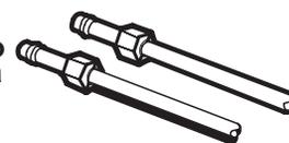
Si su tubería de cobre actual cuenta con alguna reducción en los extremos, necesitará un adaptador (disponible en las ferreterías) para conectar la línea de agua al refrigerador. También puede cortar la reducción con un cortador de tubo y después utilizar las conexiones de compresión arriba mencionadas.
