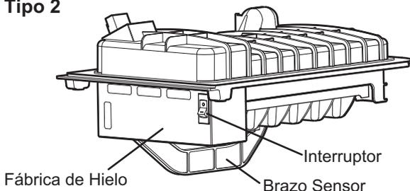
La fábrica de hielos produce 12 cubos por ciclo (entre 80 y 100 cubos en un período de 24 horas, dependiendo de la temperatura del compartimento del congelador, número de veces en las que se abre la puerta y otras condiciones de uso).
