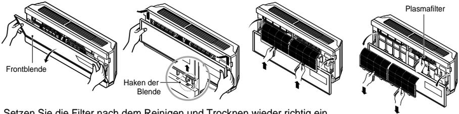
Setzen Sie die Filter nach dem Reinigen und Trocknen wieder richtig ein.
