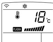
Die Plasmafilter-Technologie wurde von LG entwickelt, um die einströmende Luft durch Erzeugung eines Plasmas aus Elektronen mit hoher Ladung von mikroskopischen kleinen Verunreinigungen zu befreien. Das Plasma beseitigt die Verunreinigungen vollständig und sorgt so für eine saubere und hygienische Raumluft.
