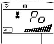
Die Schnellkühlfunktion dient zum schnellen Abkühlen der Raumtemperatur im Sommer. In dieser Betriebsart wird das Klimagerät 30 Minuten lang im Kühlungsbetrieb mit sehr hoher Lüftergeschwindigkeit und einer Temperatureinstellung von 18°C betrieben, um den Raum schnell abzukühlen.
