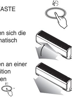
Der horizontale Luftstrom (nach links/nach rechts) kann über die Fernbedienung angepasst werden.
