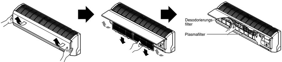
**Modell 2:** Klappen Sie die Frontblende an beiden Seiten wie in der Abbildung nach oben. Ziehen Sie dann die Filterhalterung zum Herausnehmen der Filter leicht nach vorne. Nehmen Sie zuerst den Luftfilter heraus und ziehen Sie den Plasma- sowie den Dreifach-Desodorierungsfilter leicht nach vorne heraus.
