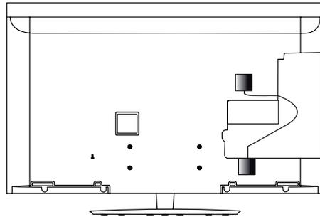
\*Falls das HF-Dongle für die Funk-Media-Box angeschlossen wurde, schließen Sie das HF-Dongle für die Magic Motion-Fernbedienung unten, rechts auf der Rückseite des Fernsehgerätes an.
