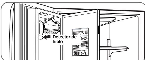
**NOTA:** Evite tocar el sensor de la cubitera al volver a colocar el depósito de hielo. Consulte la etiqueta de la puerta del compartimiento de hielo para conocer más detalles.
