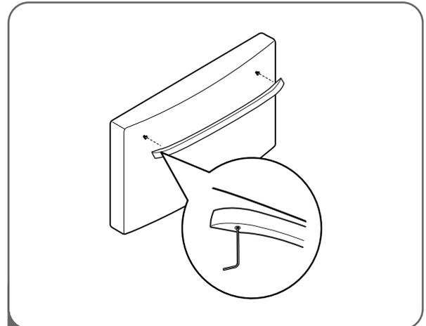
2 Coloque el tirador en la puerta, alineándolo según su plantilla, para fijar los pasadores de montaje y apriete los tornillos del conjunto en la parte de abajo del tirador con ayuda de una llave Allen de 3,1 mm (1/8").
