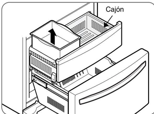
Para separar el recipiente de hielo, extienda el cajón por completo. Con suavidad, levante y quite el recipiente de hielo. Para volver a instalar, coloque el recipiente de hielo en su posición correcta.
