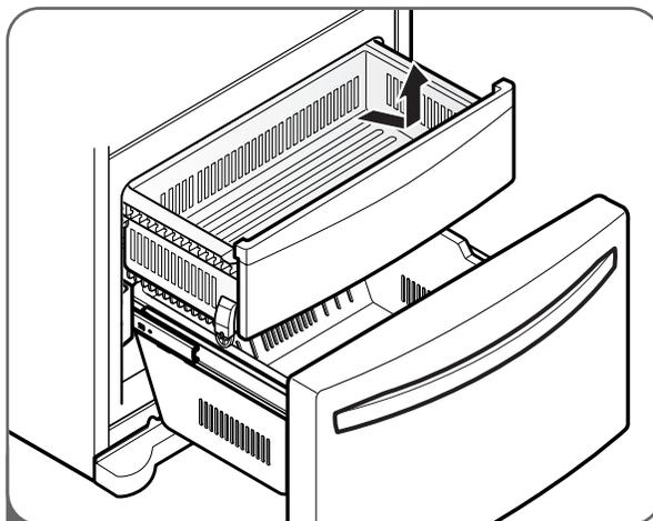
1 Para sacar el cajón, empuje las lengüetas situadas en la superficie interior delantera de cada raíl.
