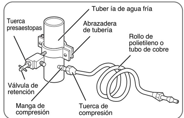
**IMPORTANTE:** Antes de conectar la tubería al refrigerador, asegúrese de que el cable de energía del refrigerador no esté enchufado en el tomacorriente.
