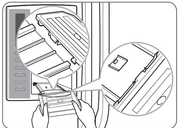
La bandeja de goteo del dispensador no tiene función autovaciante. Debe limpiarse de manera regular. Retire la tapa presionando y tirando de la bandeja. Séquela con un paño. Para reinstalar la bandeja, incline un poco el frente de la bandeja e introduzca los rebordes dentro de los orificios.
