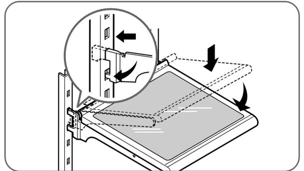
Incline el frente del estante y guíe los ganchos del estante dentro de las ranuras a la altura deseada. Luego baje el frente del estante para que los ganchos encajen en las ranuras.
