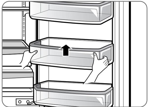
Los recipientes de la puerta son desmontables para una limpieza y ajuste sencillos. Sólo levante el recipiente y tire de él para retirarlo. Para volver a colocarlo, deslícelo sobre el soporte deseado y empújelo hacia abajo hasta que se detenga.
