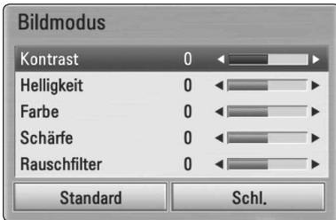
4. Nehmen Sie mit den Tasten  $\wedge / \vee / \lt / \gt$  die Einstellungen für den [Bildmodus] vor. Wählen Sie die Option [Standard] und drücken Sie ENTER (O), um die Bildeinstellungen zurückzusetzen.
