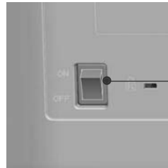
Commutateur de mise sous tension
