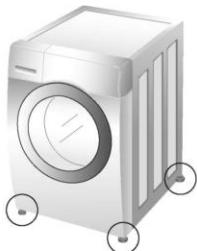
1. Pravilnim nivelišanjem mašine sprečićete nastanak buke i vibracija. Instalirajte mašinu na mesto koje ima ravnu i čvrstu podlogu, najbolje u ugao prostorije.
