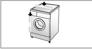
1. Das korrekte Nivellieren oder Ausrichten der Waschmaschine verhindert übermäßiges Geräusch und starke Vibration. Das Gerät auf festem, flachem Untergrund stellen - am besten in eine Ecke.
