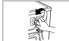
2. Den Wasserzulaufschlauch abschrauben.
