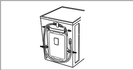
1. Das Gerät ist durch 4 Spezialschrauben gesichert, um Transportschäden zu verhindern. Vor der Inbetriebnahme die Schrauben zusammen mit den Gummipropfen entfernen.
