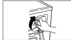
4. Den Wasserzulaufschlauch abschrauben.
