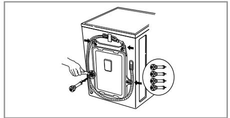
3. Die 4 Schrauben lösen und die Gummipropfen etwas drehen, um sie zusammen mit den Schrauben abzunehmen. Die 4 Schrauben und den Schraubenschlüssel für späteren Gebrauch aufbewahren.
