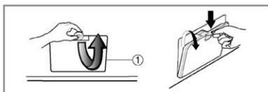
1. Abra la tapa de la cubierta inferior. Gire el tapón de drenaje para sacar la manguera.
