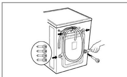
**1.** Para impedir los daños internos durante el transporte, los 4 tornillos especiales están bloqueados. Antes de hacer funcionar la lavadora, quite los tornillos junto con los tapones de caucho.
