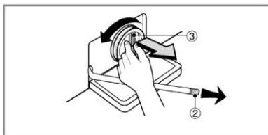
2. Desconecte el tapón de drenaje (2) dejando que el agua fluya hacia fuera. En este momento utilice un recipiente para impedir que el agua caiga al suelo. Si ya no sale agua, gire el filtro de la desagüe (3) a la izquierda hasta abrirlo totalmente.
