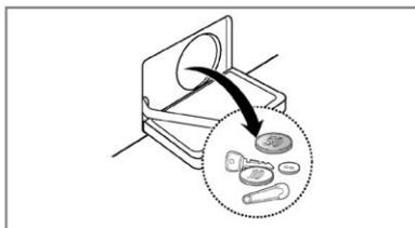
3. Saque cualquier material extraño del filtro de la desagüe (3).
