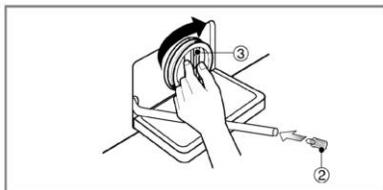
4. Después de la limpieza, gire el filtro de la desagüe (3) en el sentido de las agujas del reloj e inserte el tapón de drenaje (2) en su lugar original. Cierre el tapón de la cubierta inferior.
