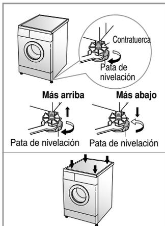
1. La nivelación correcta de una lavadora impide el ruido y la vibración excesivos. Instale el aparato sobre una superficie de suelo sólida y nivelada, preferiblemente en la esquina de una habitación.
