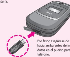
Por favor asegúrese de que el lado 'B' esté orientado hacia arriba antes de insertar el cargador o cable de datos en el puerto para cargador y accesorios de su teléfono.
