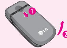
2. Levante la batería (1) y retírela (2) del teléfono, como se muestra a continuación.
