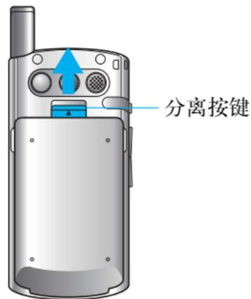
拔出时，将手机上的分离按键往上推，同时将电池往下拉。
