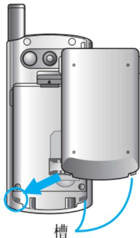
将电池“底部”和手机“底部槽”对正后按下去，直到听见“咔嚓”的响声。
