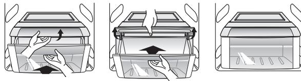
\* Quando for instalar a gaveta, levante sempre a tampa e empurre-o para dentro.
