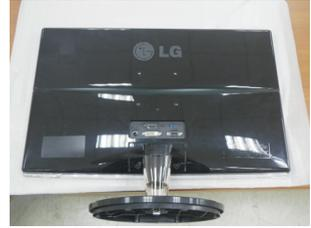
2. Wenn Sie den Monitor vom Standfuß trennen möchten, nehmen Sie eine Münze und drehen Sie die Schraube entgegen dem Uhrzeigersinn.
