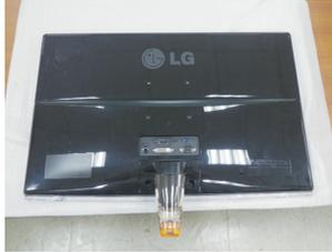
2. Nehmen Sie eine Münze und drehen Sie die Schraube auf der Rückseite des Standfußes im Uhrzeigersinn fest.
