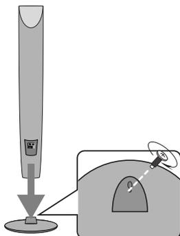
2. Если вы хотите закрепить кабель колонки – просуньте кабель через отверстие в колонке.
