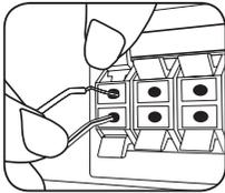
Подсоедините черный провод каждого кабеля к гнездам, отмеченным «-» (минус), а другой - к гнездам, отмеченным «+» (плюс).
