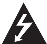
Este símbolo de relámpago con punta de flecha dentro de un triángulo equilátero está diseñado para alertar al usuario de la presencia de voltajes peligrosos no aislados en el interior del producto, que podrían tener la suficiente magnitud como para constituir un riesgo de descarga eléctrica.
