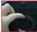
Wenn Sie den Monitor vom Standfuß trennen möchten, nehmen Sie eine Münze und drehen Sie die Schraube entgegen dem Uhrzeigersinn.
