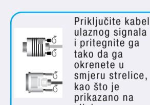
Priklučite kabel ulaznog signala i pritegnite ga tako da ga okrenete u smjeru strelice, kao što je prikazano na slici.
