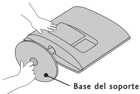
**3** Gire la fijación de base de soporte 90° para fijar la base de soporte al cuerpo de la base.
