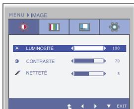
**LUMINOSITÉ** Réglage de la luminosité de l'écran.
