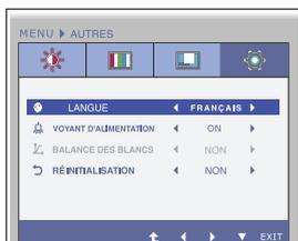
**BALANCE DES BLANCS** Si la sortie de la carte vidéo diverge des spécifications requises, le niveau des couleurs peut être dégénéré en raison d'une distorsion du signal vidéo. À l'aide de cette fonction, le niveau du signal est réglé pour adapter le niveau de sortie standard de la carte vidéo afin de fournir l'image optimale.
