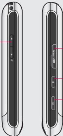
Micro SD 存储卡插槽
